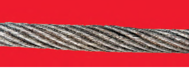
l. Öz hasarlanmasından dolayı çaptaki lokal artışlar
