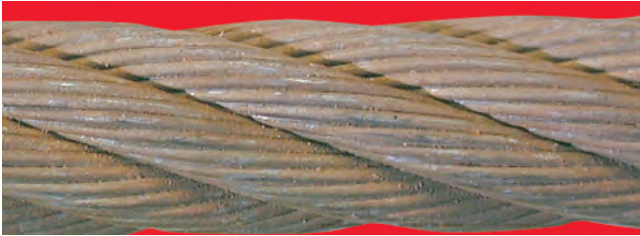
a. Yüzey oksidasyonu başlangıcı, yüzeysel olarak temizlenebilir oksidasyon var ise - Değerlendirme: %0 (Kombine etki metoduna katılacak değer)
