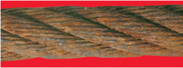
c. Halat yüzeyi oksidasyondan büyük ölçüde etkilenmeye başlamışsa - Değerlendirme: %60 (Kombine etki metoduna katılacak değer)
