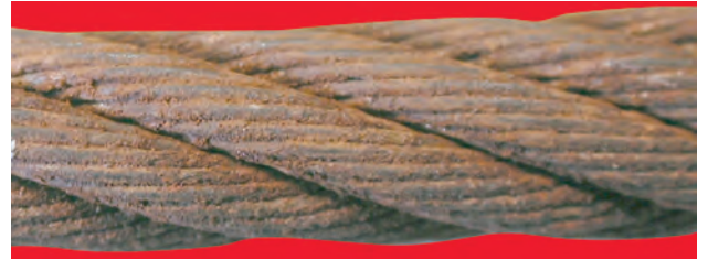
b. Dış tellerde genel yüzey oksidasyonu başlamışsa - Değerlendirme: %20 (Kombine etki metoduna katılacak değer)
