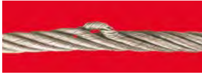
a. Damar çıkması ya da bükülmesi
