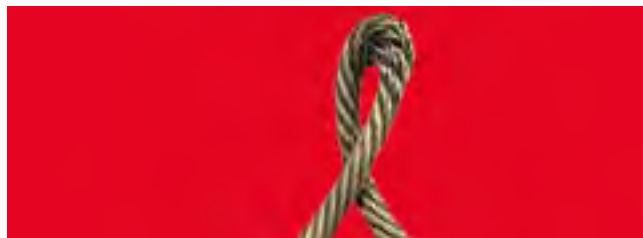
k. Dönme dayanımlı halatlarda özün dışarı çıkması
