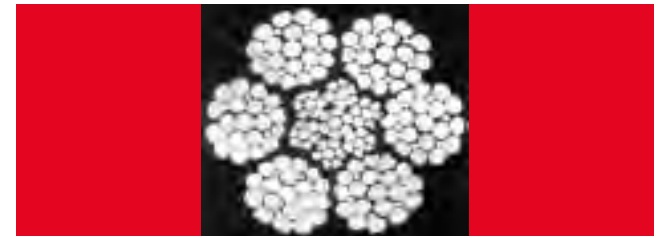
o. İç korozyon
