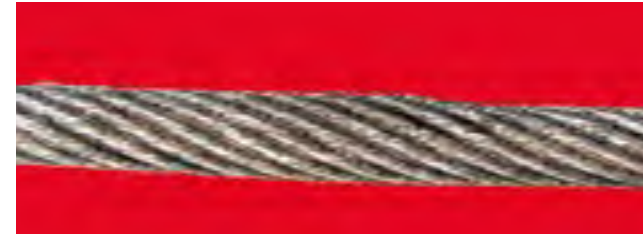
l. Öz hasarlanmasından dolayı çaptaki lokal artışlar
