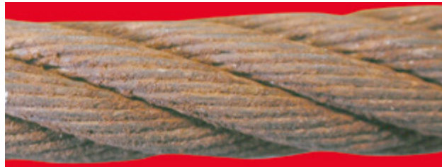
b. Dış tellerde genel yüzey oksidasyonu başlamışsa - Değerlendirme: %20 (Kombine etki metoduna katılacak değer)
