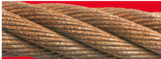
ı. Dış korozyonun yakınlaştırılmış şekli
