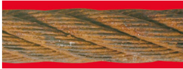
d. Halatın oksidasyon nedeni ile malzeme kaybı yaşamaya başlaması - Değerlendirme: %100 (Halatı acilen servis dışına alınmalıdır)
